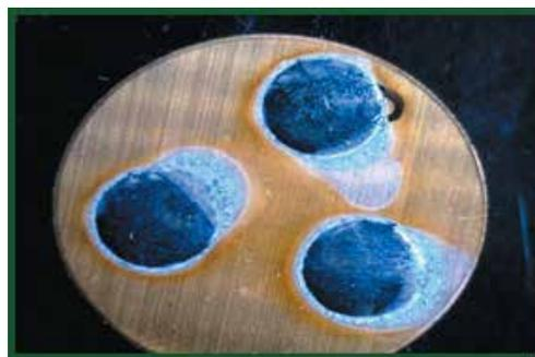
**4** Паяльная паста серии Indium6.4 со сплавом Indalloy #100® после отмывки в деионизированной воде
