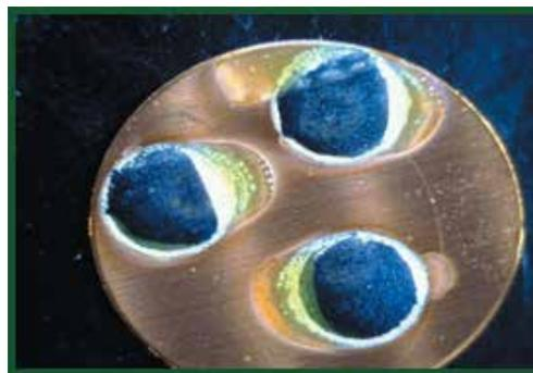
**3** Паяльная паста серии Indium6.4 со сплавом Indalloy #100® после оплавления
